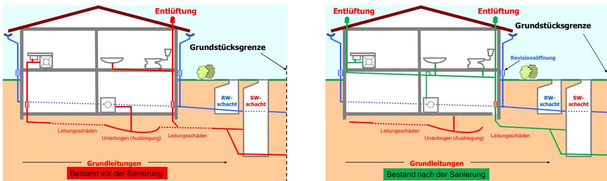
Abb.: Erneuerung einer schwer zugänglichen Leitung (rot) durch stilllegen des Altrohres und abhängen der neuen Leitung unterhalb der Decke (grün)
